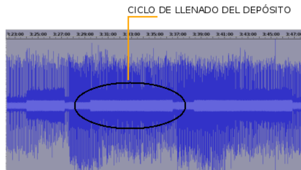
Figura 10. Evolución del tiempo de llenado del depósito del compresor de aire con velocidades de pistoneo crecientes.
